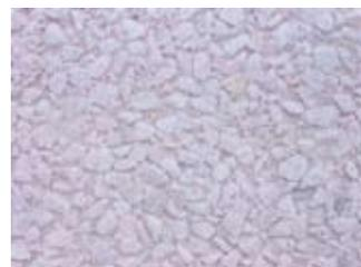
h) La foto de la izquierda muestra la superficie de hormigón con cemento blanco y marmolina blanca, usando CSE-Desactivador nova 005 con un ataque de aprox. 0,3
